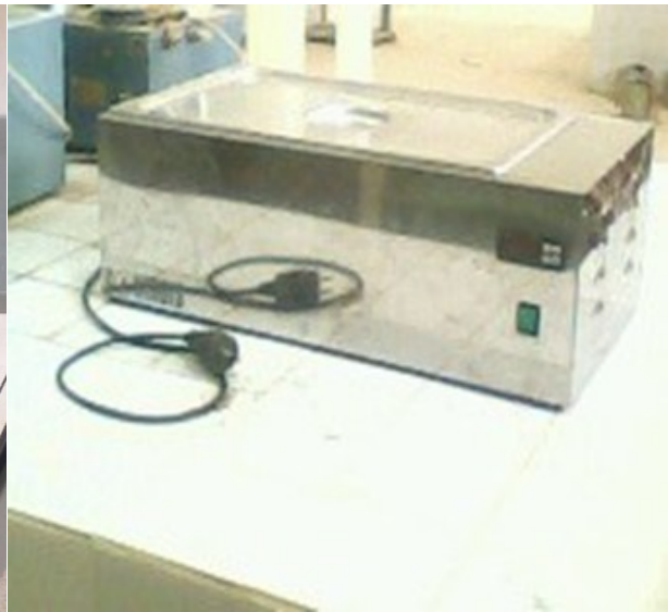
Figure IV. 19. Appareil de mise en ébullition des éprouvettes (essais de porosité)
