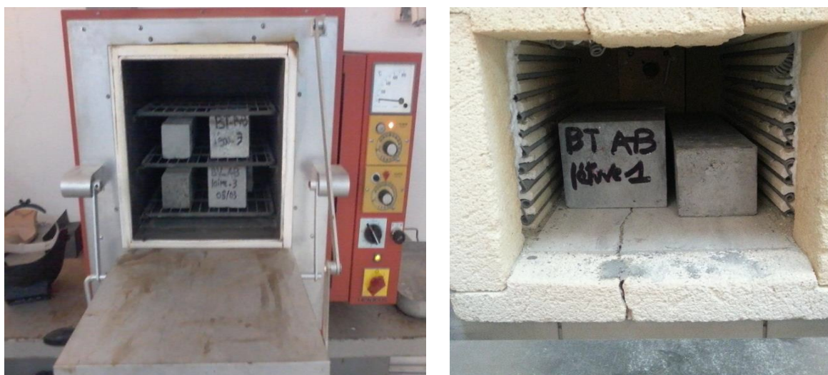
Figure IV.11. Disposition des éprouvettes dans les fours
