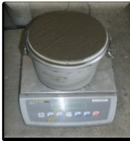
Figure IV. 14. Mesure de la densité du béton à l'état frais
