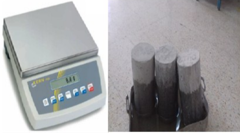
Figure IV. 18. Essai d'absorption d'eau par capillarité.
