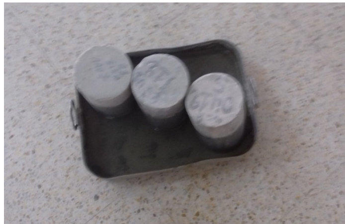
Figure IV. 21. Dispositif expérimental pour l'essai d'absorption d'eau par capillarité
