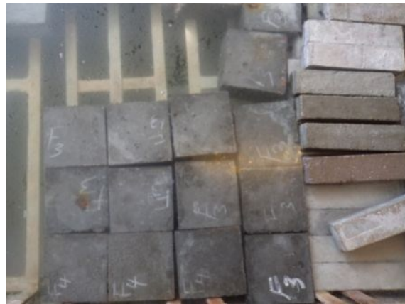
Figure IV.10. Conservation les éprouvettes dans l'eau.
