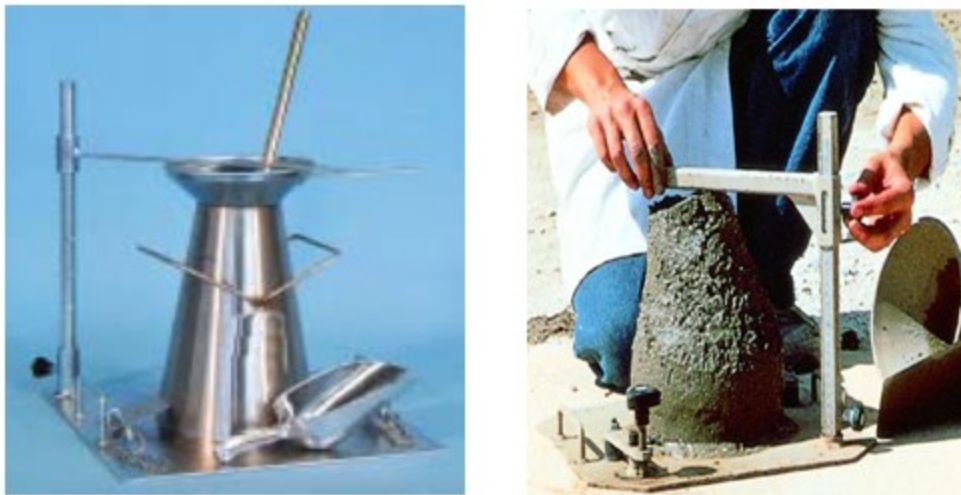
Figure IV. 12. Mesure l'affaissement du béton
