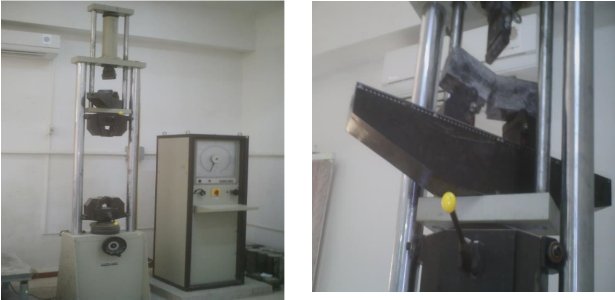
Figure.IV.16. Dispositif d'essai de traction par flexion
