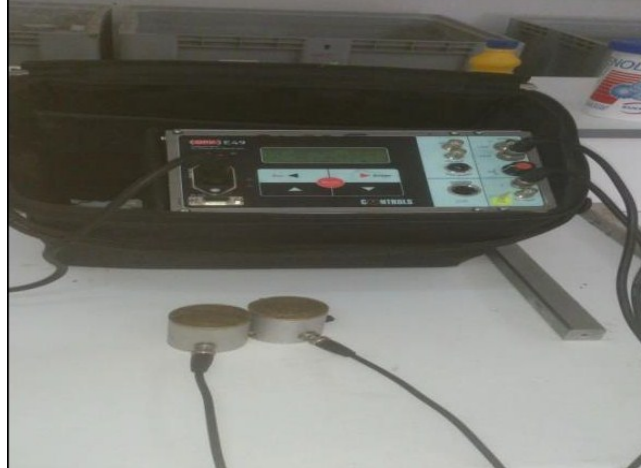
Figure II.23. Appareil à ultrasons hautes performances et ses équipements.
