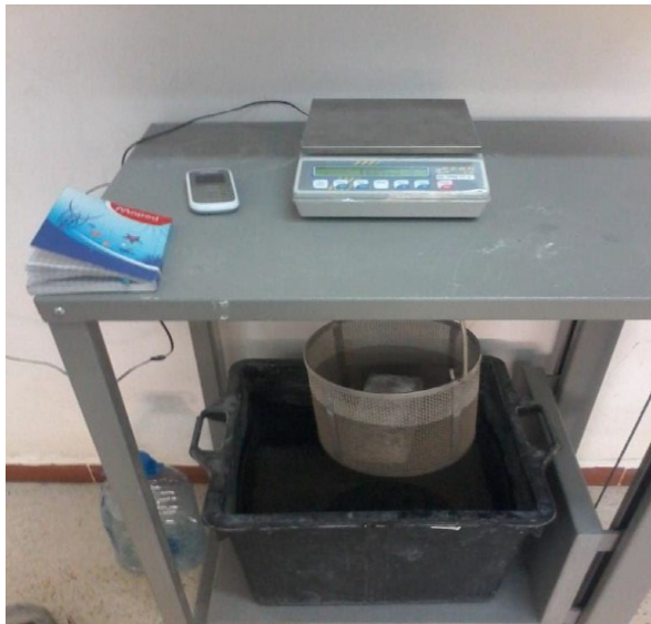
Figure IV. 20. Pesé hydrostatique des éprouvettes pour calculé la porosité
