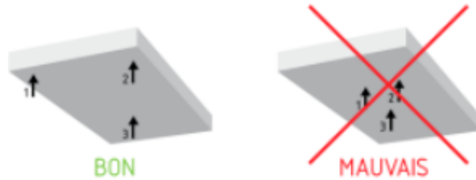
Figure II. 15: la mise en position doit assurer une bonne stabilité à la pièce
