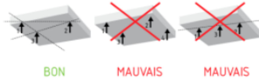
Figure II. 17 : l'emplacement des normales dans le même plan
