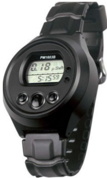
FIG. 3-1 – Dosimètre sous forme de montre [19].
