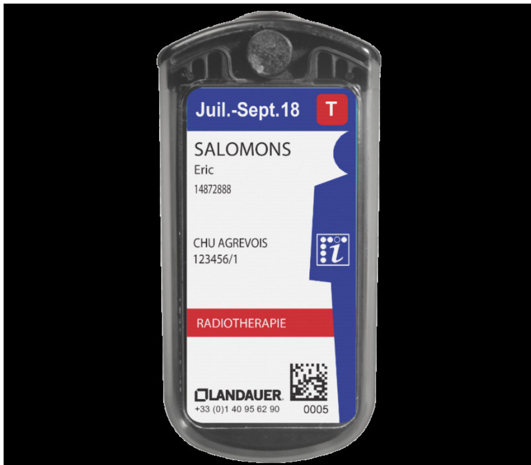
FIG. 2-10 – Exemple de dosimètre passif [8]
