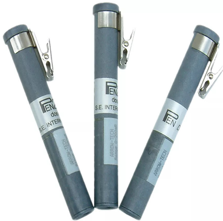
FIG. 3-2 – Dosimètre en forme de stylo [20]
