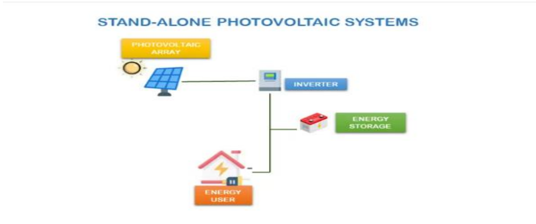
Figure I. 9 : Système solaire autonome
