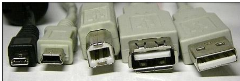
Figure I.15 : Aspect des connecteurs USB de type A et B.
