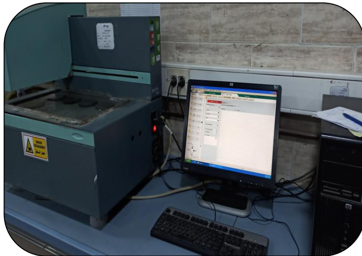
Figure IV. 9 : L'appareil de Vicat automatique. (Laboratoire de lafargeholcim M'sila)
