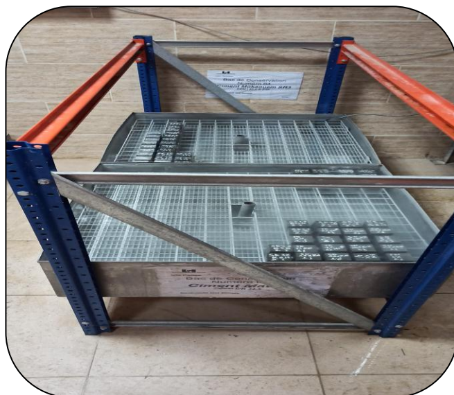
Figure IV. 7 : Conservation des éprouvettes dans l'eau. ( 20^\circ\text{C} \pm 1 ) (Laboratoire de lafargeholcim M'sila)
