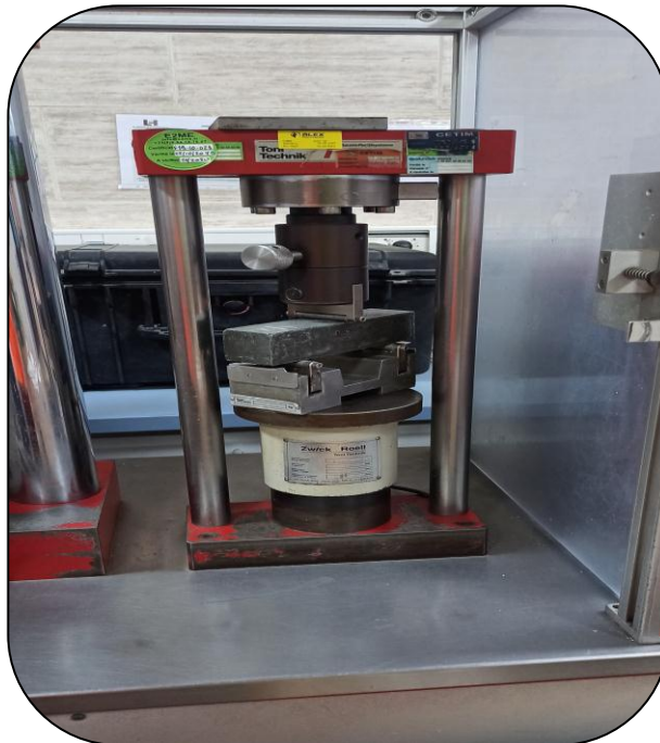
Figure IV. 13 : Essai de flexion. (Laboratoire de lafargeholcim M'sila)
