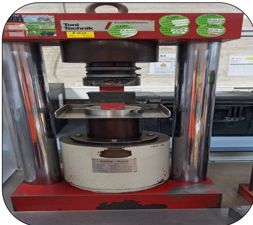
Figure IV. 15 : Epreuve testée en compression. (Laboratoire de lafargeholcim M'sila)
