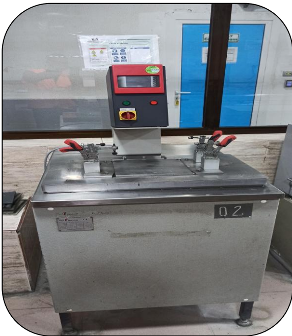
Figure IV. 4 : Table vibrante automatique (Laboratoire de lafargeholcim M'sila)
