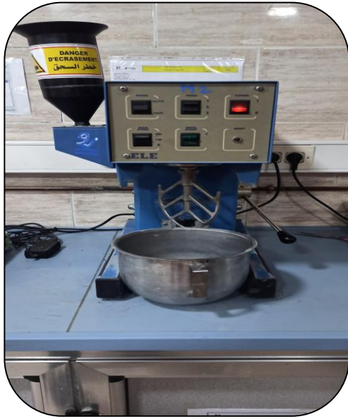
Figure IV. 3: Malaxeur semi-automatique De mortier (Laboratoire de lafargeholcim M'sila)
