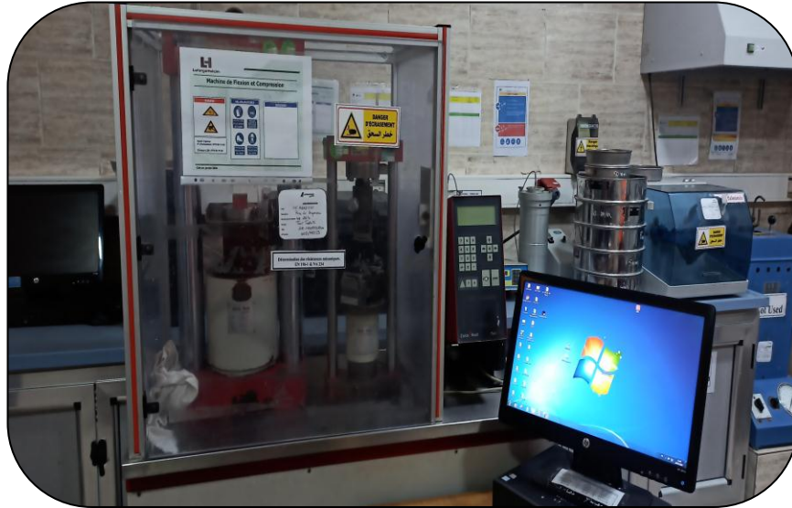
Figure IV. 11 : Appareil automatique de compression et de flexion des mortiers. (Laboratoire de lafargeholcim M'sila)
