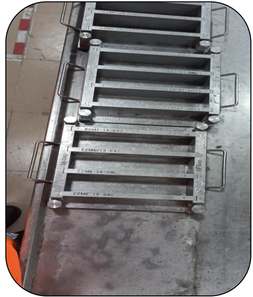
Figure IV. 2: Eprouvette prismatique 4x4x16 (Laboratoire de lafargeholcim M'sila)
