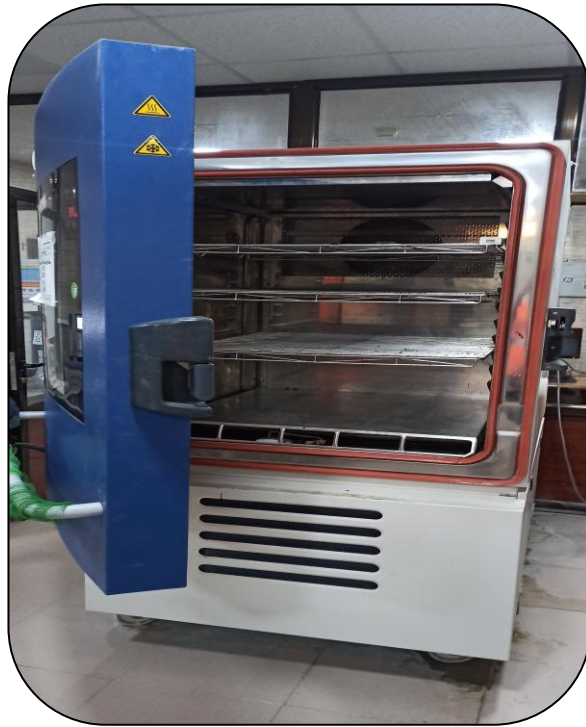
Figure IV.6: La Chambre d'humidité 20°C (Laboratoire de lafargeholcim M'sila)
