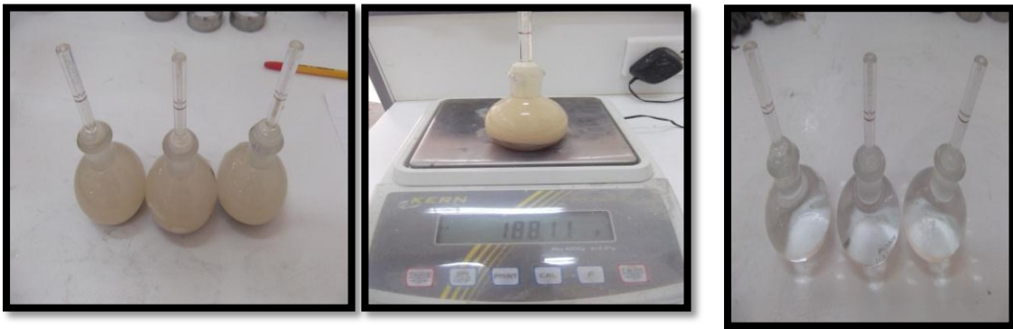
Lafigure(II.15):Appareillage de la masse volumique absolue
