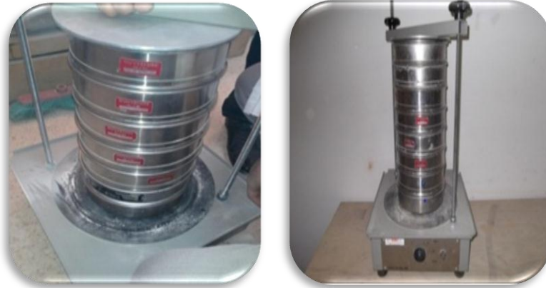
Fig. II.2.Série des tamis sur la tamiseuse.
