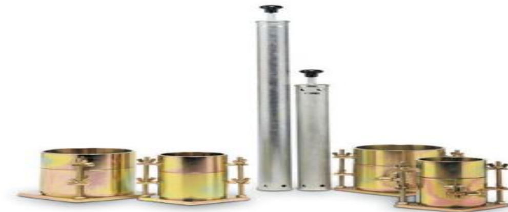
Fig. II.10 : Appareillage spécifique pour essais de compactage
