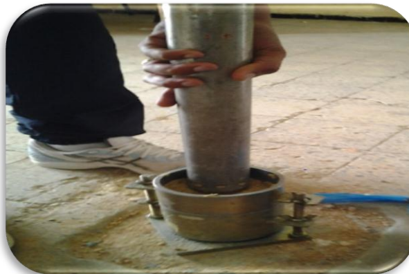
Fig. II-11:préparation d'essai Proctor
