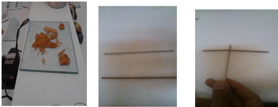
Fig. II.8: Les étapes de la limite de plasticité.
