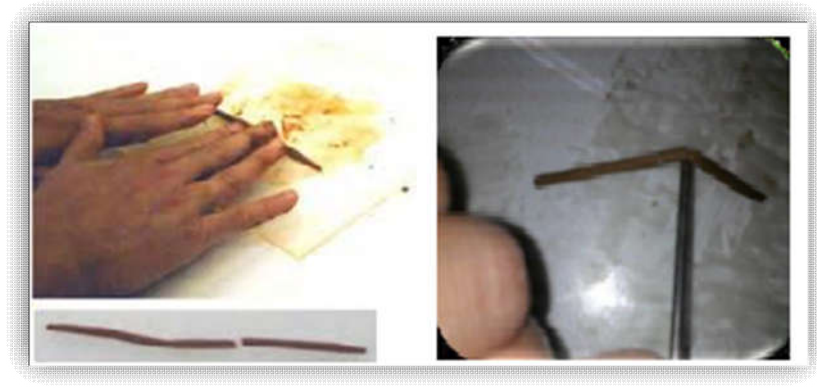
Figure II.8: les étapes de limite de plasticité.
