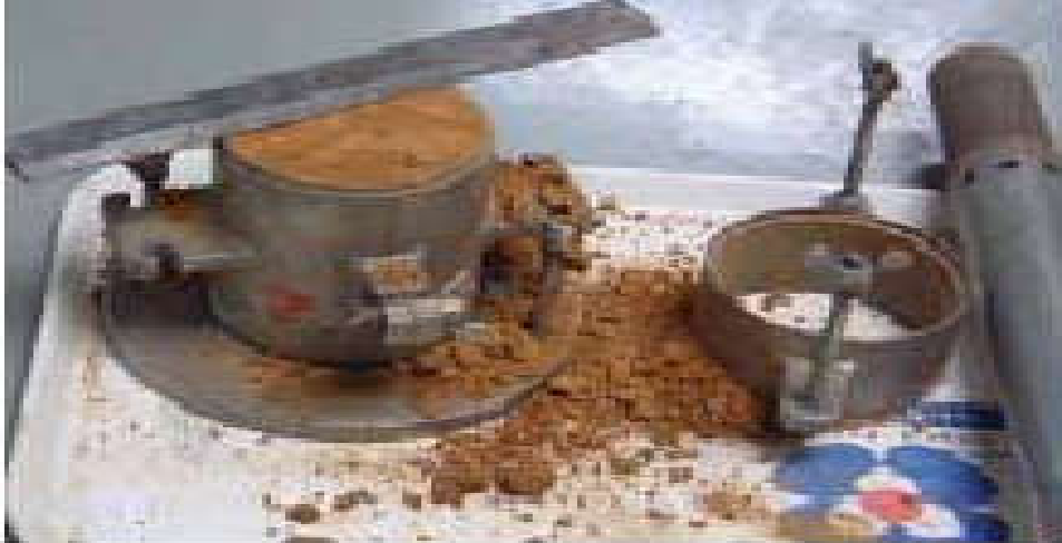
Figure. II.14: Mode opératoire pour l'essai Proctor.
