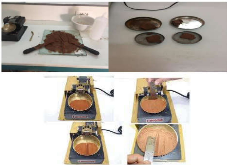
Figure II.8: Les étapes de limite de liquidité.
