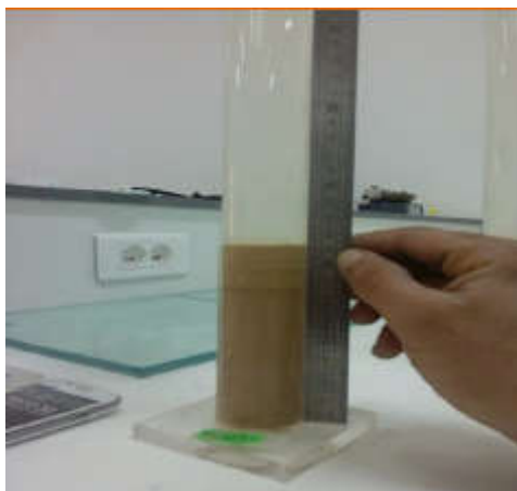
Figure II.6: Lire la hauteur H1 et H2.
