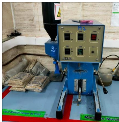
Figure III. 10: Malaxeur à mortier normalisé.
