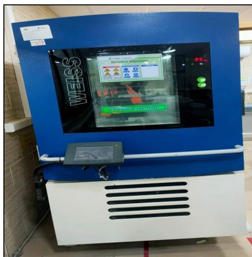
Figure III. 12: Chambre de conservation des éprouvettes.
