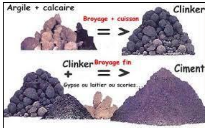
Figure I. 1: Préparation du ciment.
