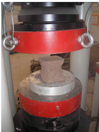
Fig-6-2- Essai de compressions sur échantillon de terre cubique
