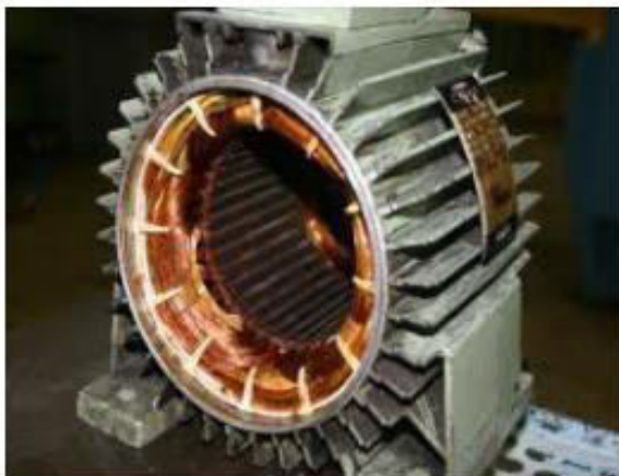
Figure.I.2.a: stator d'une machine synchrone. Figure.I.2.b: Photographie d'un rotor MSAP
