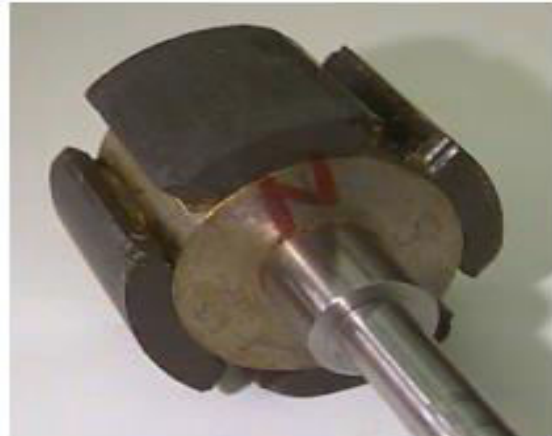
Figure.I.2.a: stator d'une machine synchrone. Figure.I.2.b: Photographie d'un rotor MSAP
