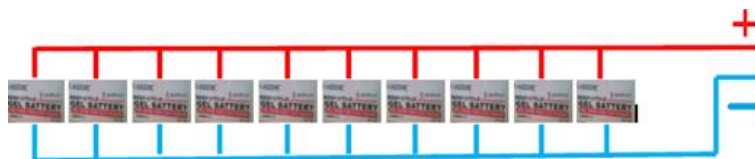
Figure (3.10) : Branchement des batteries pour maison1
