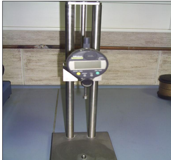
Figure III-17 -Comparateur de Retrait (Laboratoire de Lafarge M'sila)
