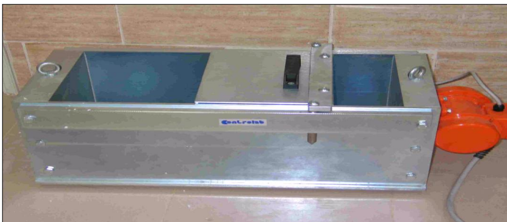
Figure III-18- Maniabilité à Mortier (Laboratoire de Lafarge M'sila).
