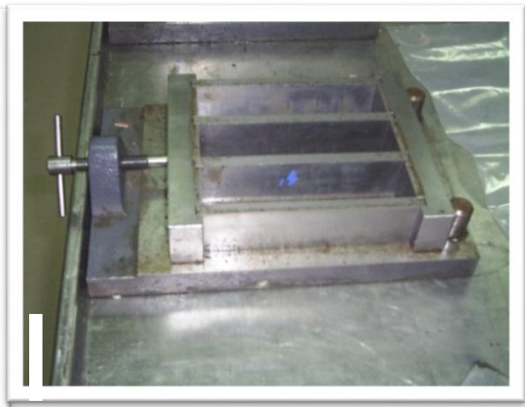
Figure III-10-Eprouvette Prismatique (4x4x16) cm 3
