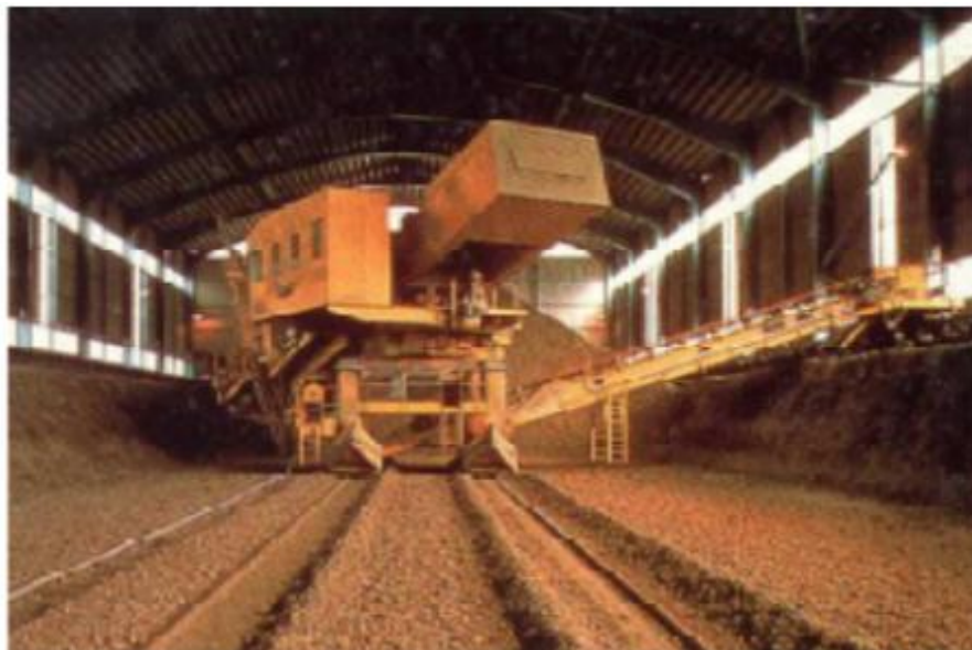
Figure I-6 : Hall de préhomogénéisation [10].
