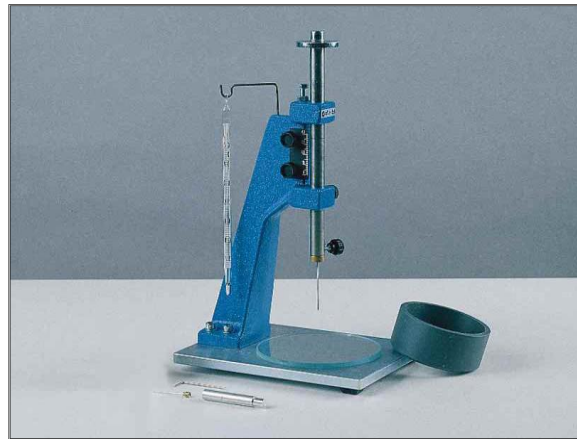
Figure I-14 : Détermination du temps de début de prise.
