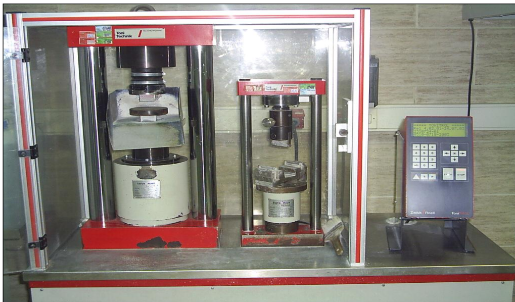
Figure III-15 -Machine de Compression (Laboratoire de Lafarge M'sila)
