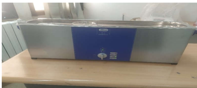
Figure II.4. Etapes de nettoyage des substrats au bain à ultrasons.
