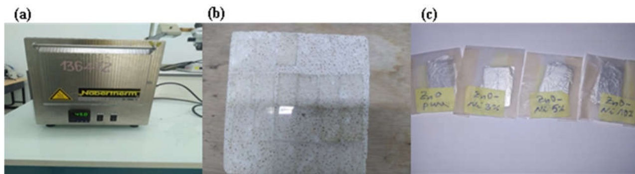
Figure II.6. Four pendant le recuit des échantillons (a), Couches minces après le recuit (b), Couches minces conservées
