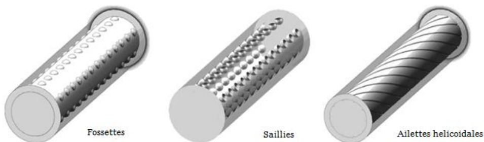
Figure II.21 Tube intérieur du PTR des fossettes, des saillies et des ailettes hélicoïdales [134].
