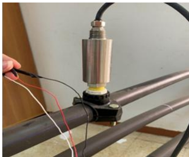
Fig. III. 8 Capteur de pression et ces fils de liaison
