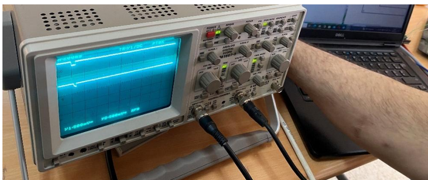
Fig.III. 19. Signaux avec fuite des deux capteurs
