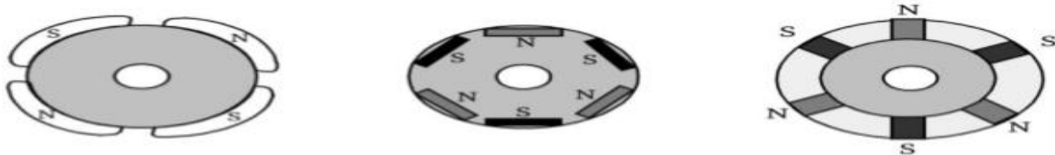
Figure II.3 sections transversales de l'aimant du rotor
