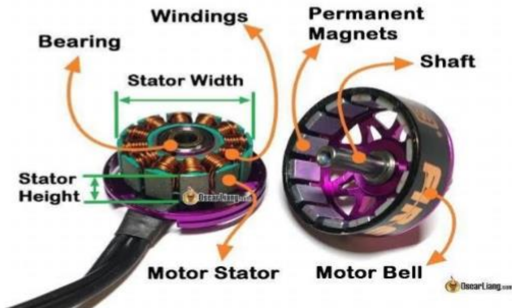
Figure II.1 : Les Composant d'un moteur BLDC
