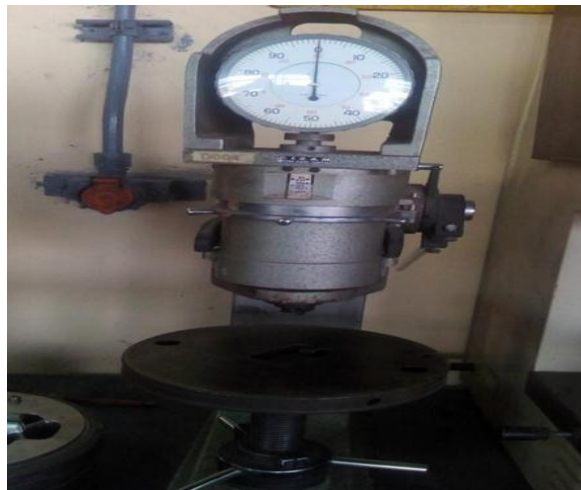
Figure.III.7. Schéma de principe d'un essai de dureté Rockwell
