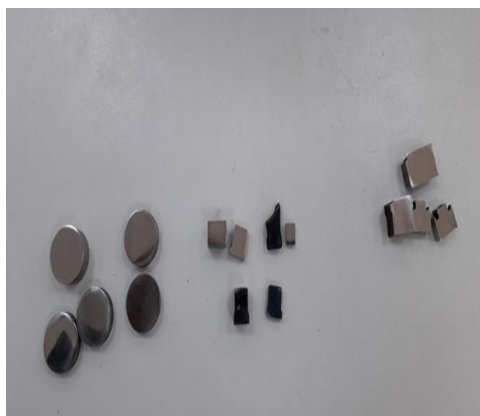
FigureIII.4.Les échantillons d'aciers nitrurés.
