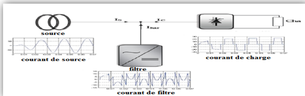
Fig. 3.1 : Principe du filtrage actif parallèle
