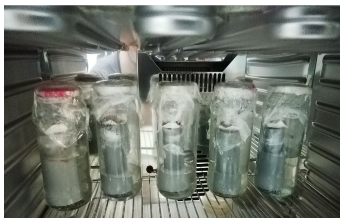
Figure 11. Photographie du dispositif expérimentale de détermination de l'isotherme d'adsorption.
