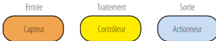
FigureII-12 : Le principe ETS
