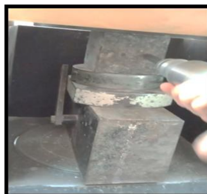
Fig.III. 16 Essai au scléromètre
