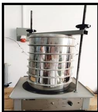
Fig.III. 3 Analyse granulométrique par tamisage
