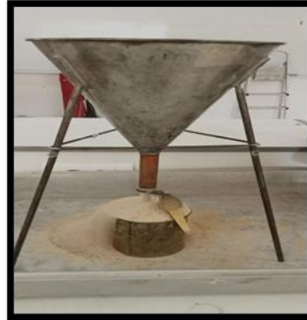
Fig.III. 2 Détermination de la masse volumique apparente.
