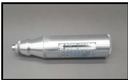
Fig.III. 16 Essai au scléromètre
