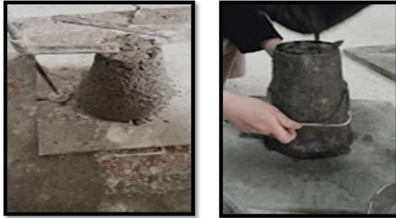
Fig.III. 11 Essai d'affaissement au cône d'Abrams
