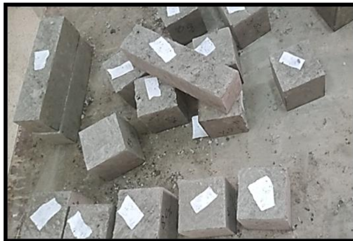
Fig.III. 10 . Etiquetage des différents bétons
