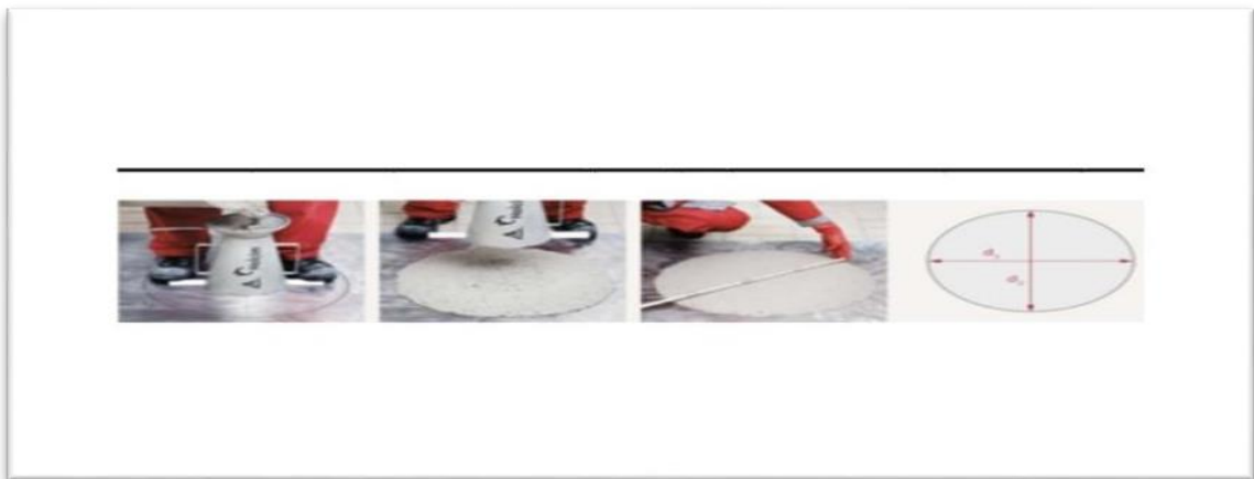
Fig.I. 6 Essai d'étalement au cône d'Abrams [2]
