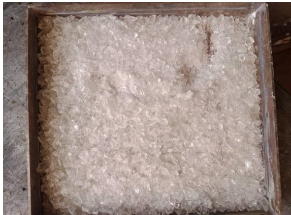
Fig VI. 10 Verre après exposition à la température 600°C
