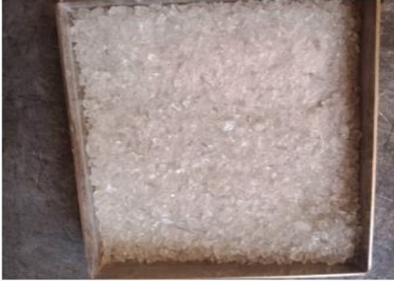
Fig VI. 8 Verre après exposition à la température 400°C
