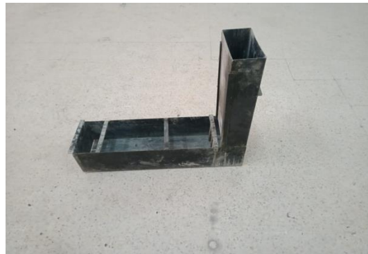
Fig V. 2 Essai de la boîte L
