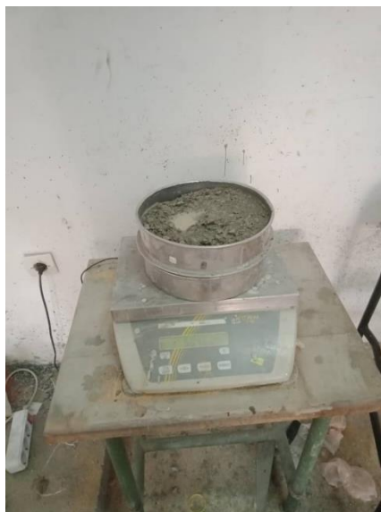
Fig V. 4 Essai de la stabilité au tamis
