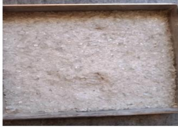
Fig VI. 9 Verre après exposition à la température 200°C
