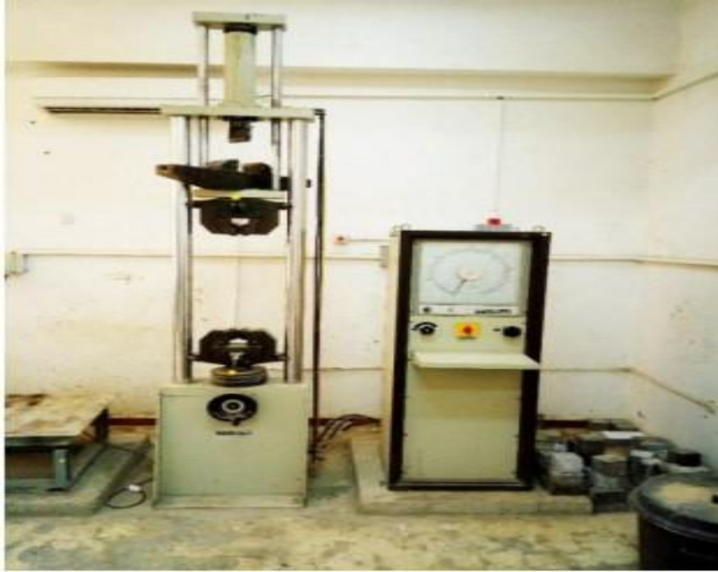
Fig V. 6 L'appareil de l'essai de traction par flexion
