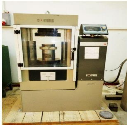
Fig V. 5 L'appareil de l'essai de compression
