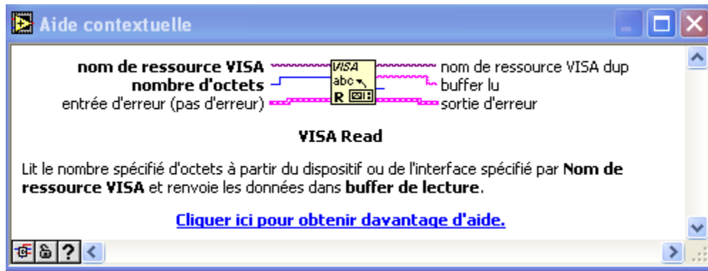
Figure II.37 Exemple de fenêtre d'aide offrant la description d'une fonction Fournie dans la bibliothèque de LabVIEW [30].
