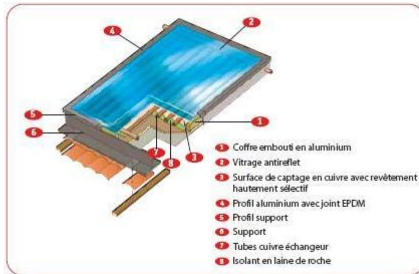
Figure I.1. Constitution du panneau thermique [6].
