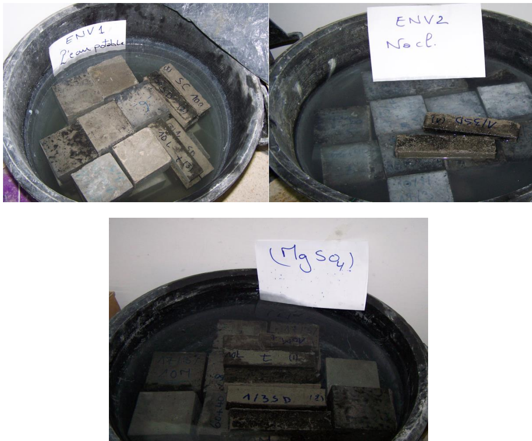
Figure IV. 15. Les échantillons du béton immergés dans les solutions agressifs ( MgSO_4 ) et ( NaCl )
