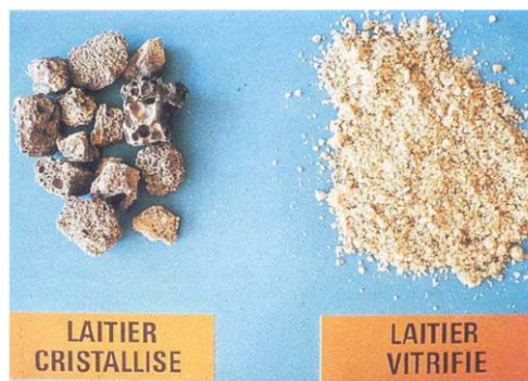
Figure III. 5. Laitier cristallisé et laitier vitrifié (granulé) de haut fourneau
