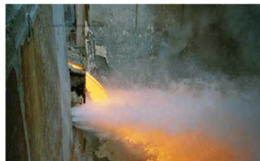
Figure III.6. Granulation du laitier de haut fourneau d'El hadjar
