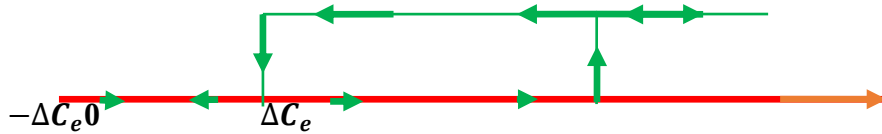
Figure. III. 5 : Comparateur à hystérésis à deux niveaux
