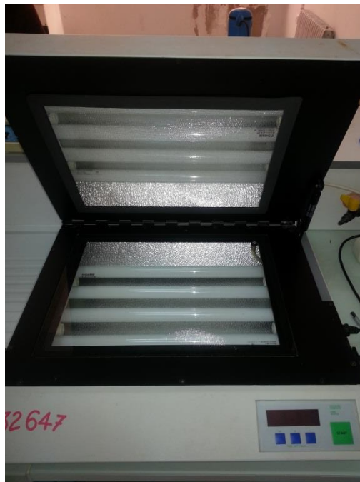
Figure IV.5 : L'insoleuse par l'ultraviolet UV.
