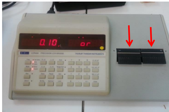
Figure IV.9 : L'appareille de mesure capacimètre
