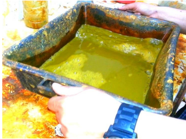
Figure IV.6 Maitre l'antenne au perchlorure de fer.
