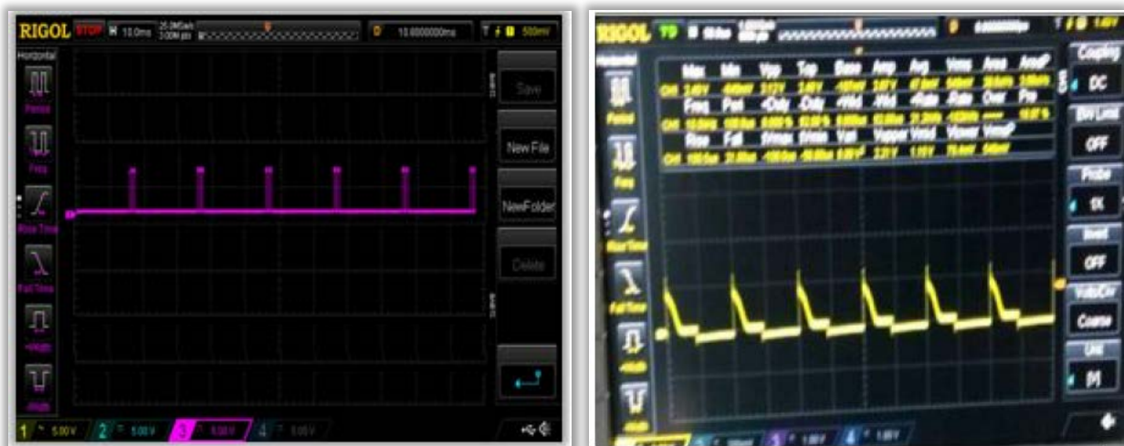
(a) L'entrée du transformateur d'impulsion. (b) La sortie du transformateur d'impulsions.
