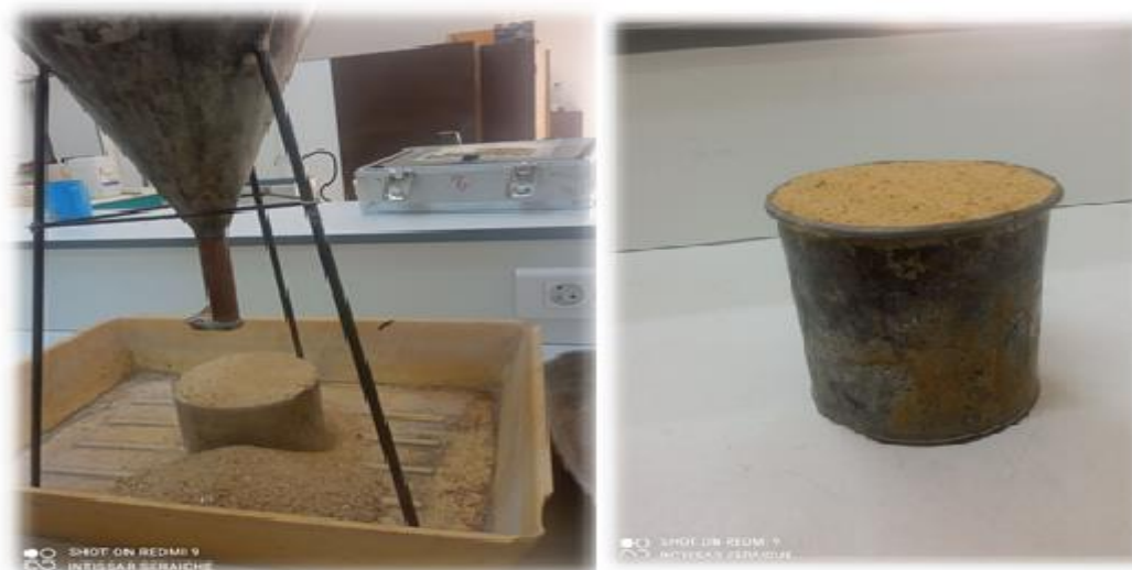
Figure III .3 : Essai de la masse volumique apparente
