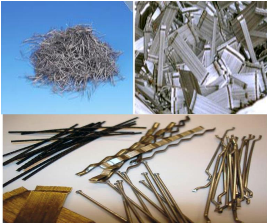
Figure II.4 : Différentes formes géométriques de fibres métalliques.
