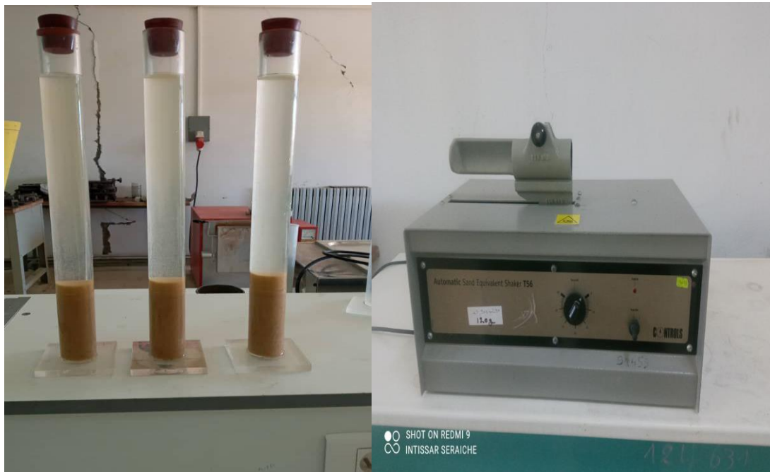
Figure III.4 : Essai de l'équivalent de sable
