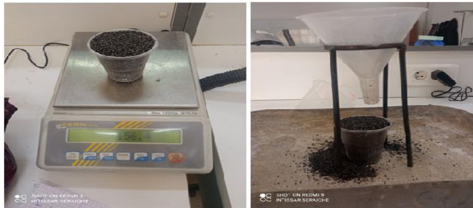
Figure III.9 : Mesure de la masse volumique apparente de la limaille de fer
