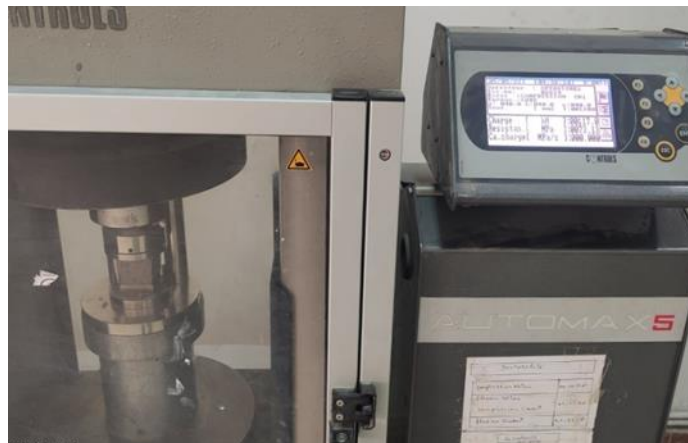
Figure.III.20: L'appareil de compression
