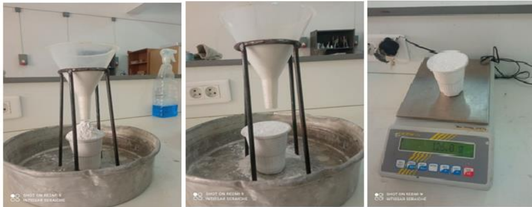
Figure III.8: Mesure de la masse volumique apparente de la poudre de verre
