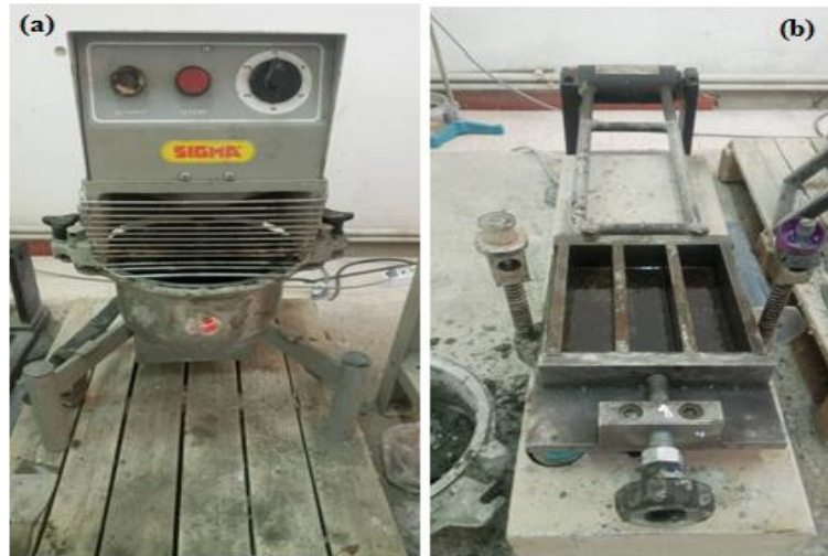
Figure III.13: Malaxage (a) et dispositif de vibration (b)
