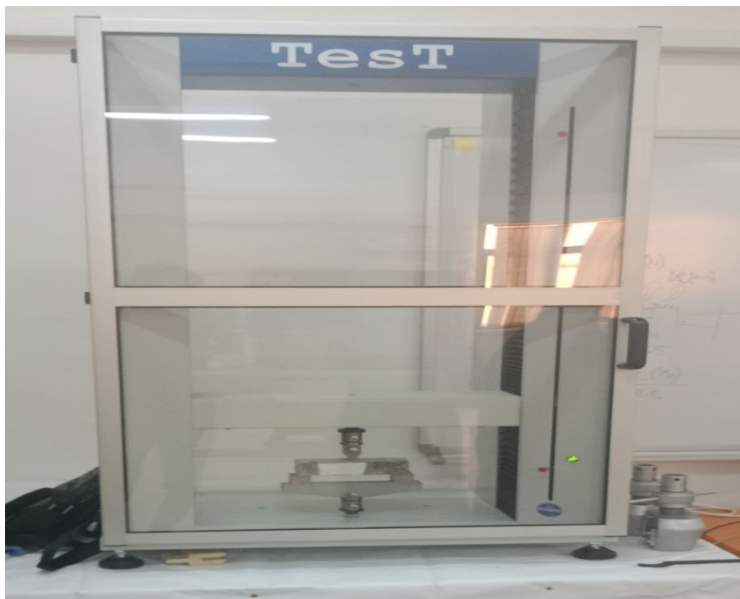
Figure III.23 : Essai de résistance à la flexion
