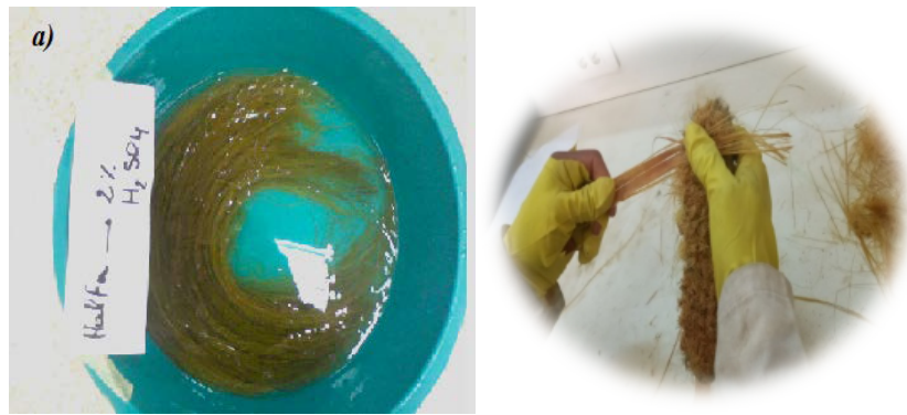
Fig. III.10. : (a) Traitement d'Alfa par H_2SO_4 pour éliminer les traces de NaOH, (b) Fibre d'Alfa traitées.
