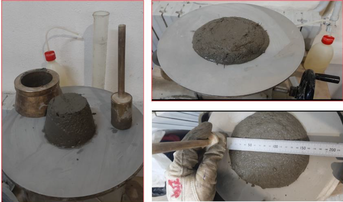
Figure III.22 : Mesure d'étalement a table de choc
