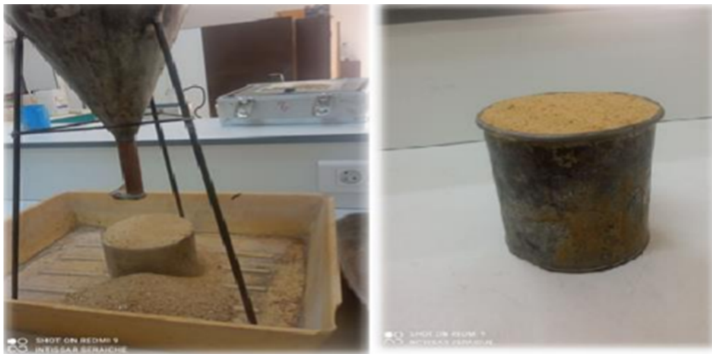
Figure III .3 : Essai de la masse volumique apparente
