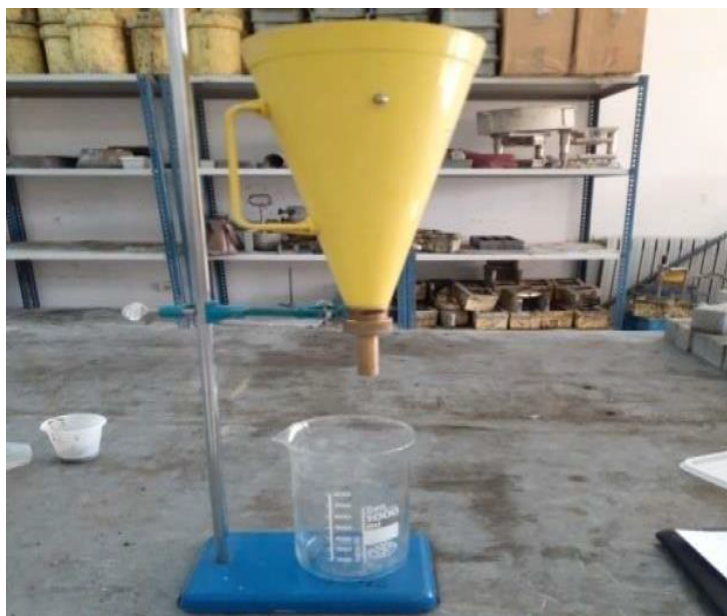
Figure II.12 : Taux de saturation par Super plastifiant. (Conne de March).
