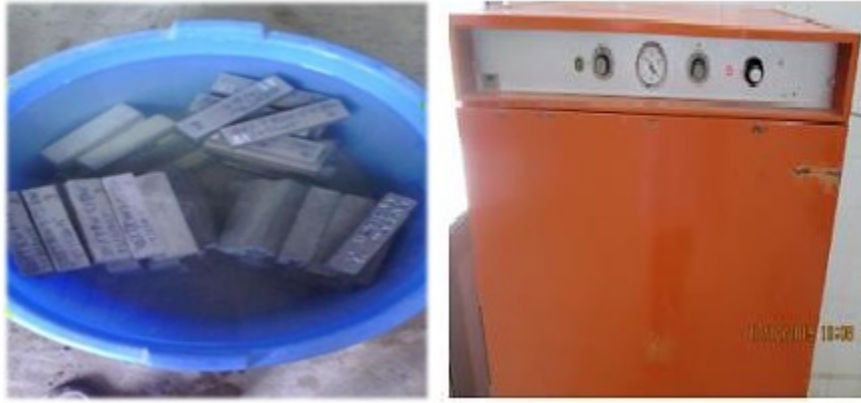
Figure III.25: Protocole de l'essai d'absorption
