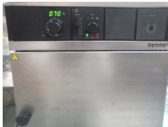
Fig. III..11: Etuve de séchage à 70^\circ C .00
