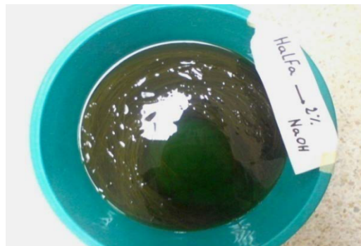
Figure III.9 : Traitement de fibre Alfa par NaOH
