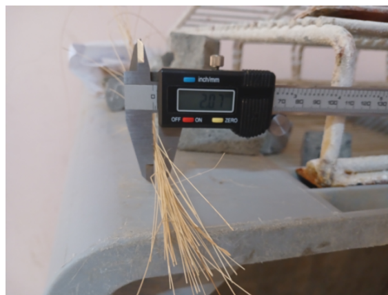
Fig.V.12 : Mesure de la longueur des différentes fibres utilisées
