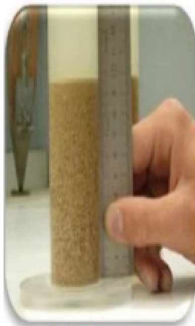
Figure III.5 : Mesure de l'équivalent de sable.
