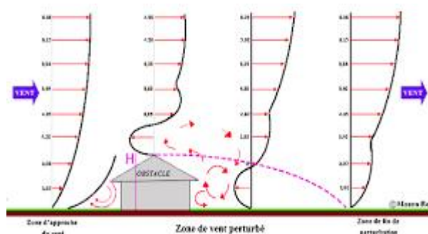
Figure I. 12: Influence d'un obstacle sur le profil vertical du vent
