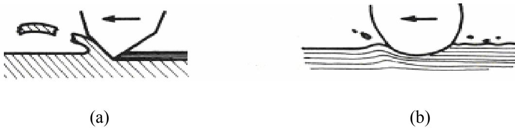
Figure II.7 : Mécanisme de l'abrasion par; (a) coupe ;(b) déformation plastique [7].
