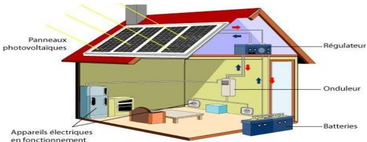
Figure I.11: Principe de fonctionnement d'un système photovoltaïque
