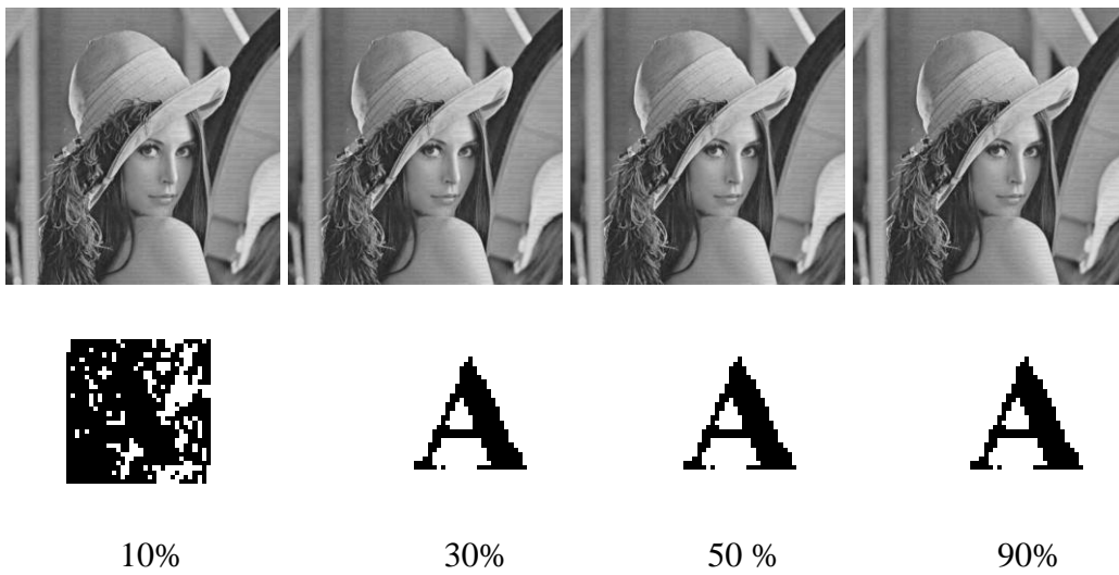
Figure III-13 : Résultats de la robustesse de l'image Lena après des attaques par compression JPEG.
