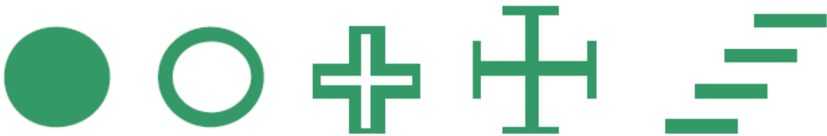
Figure2.8: Exemples de Surfaces Sélectives en Fréquence (SSF).
