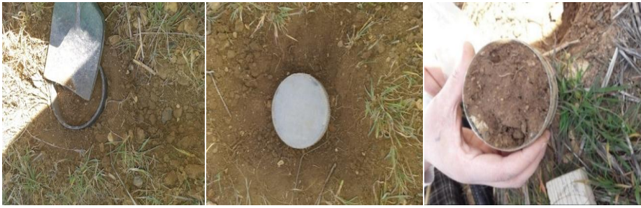
Figure 16: Méthodes de prélèvement du sol pour déterminer la densité apparente
