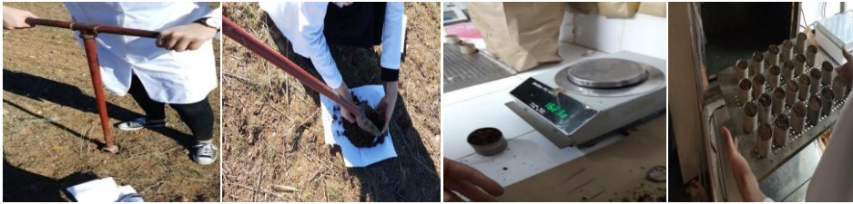
Figure 15: photo originale de station de prélèvement du sol pour déterminer l'humidité du sol.
