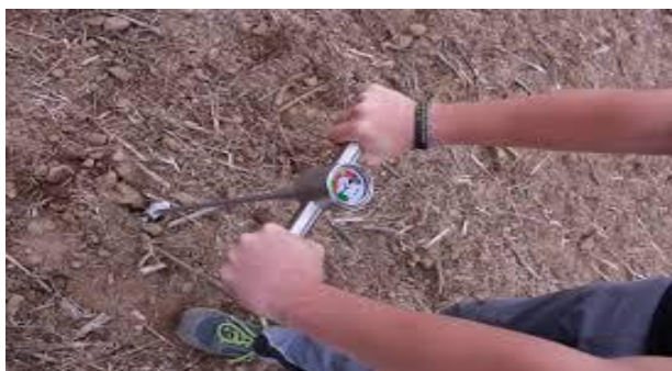
Figure 17 : operation de estimation le compactage du sol par pénètromètre.
