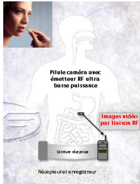
FIGURE 1 – Système à capsule endoscopique ingérable [6].
