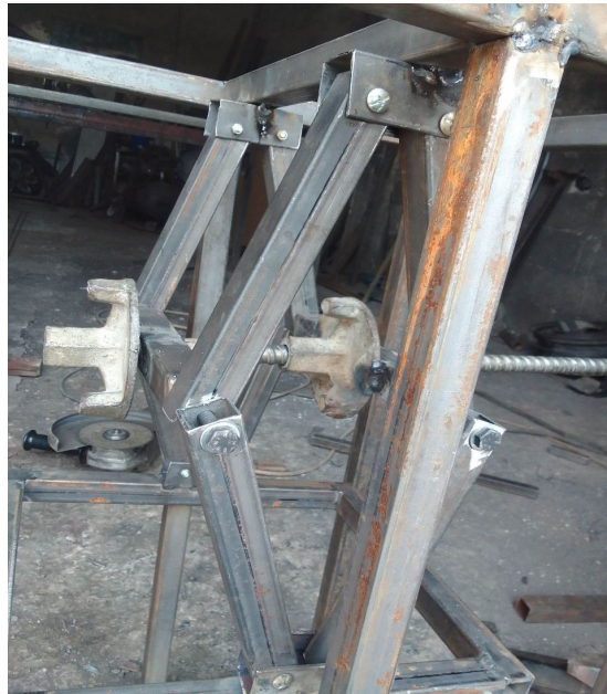
Figure 53 : Systèmes de compactage des déchets Après assemblage par soudage
