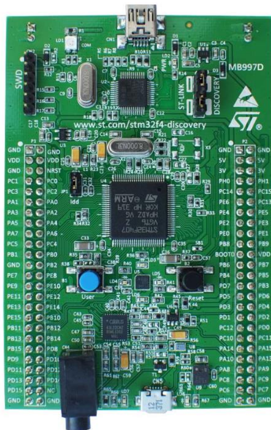
Figure II.16.: Système de pilotage stm32F407 :
