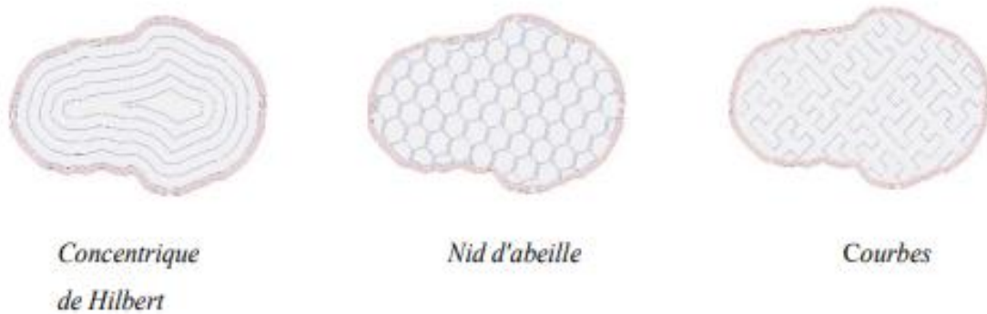
Figure I.9 : Types de remplissage de filament fondu [1]
