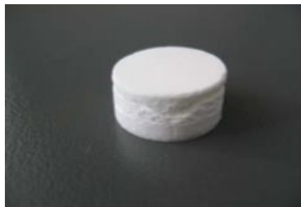
Figure III.3 : Clivage d'un compact de lactose après éjection.
