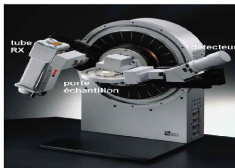
FigureII.3 : Goniomètre de la marque Bruker-AXS, type D8 [5].
