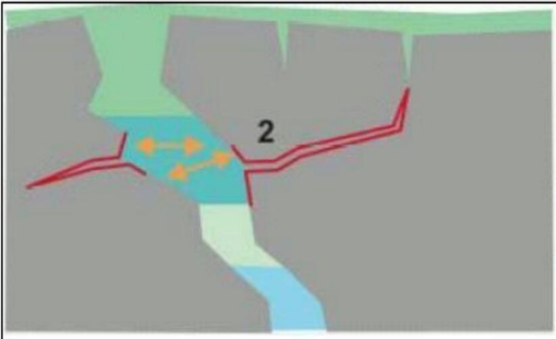
Figure I.7: Action du gel dans les fissures du béton (Amina, 11/ 07 / 2019)
