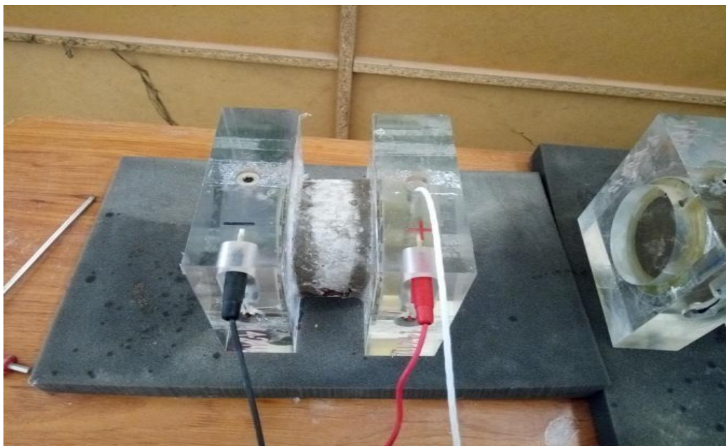
Figure III.21: Avant et aval de mesure de pénétration des ions de chlorures dans le béton(Laboratoire Développement des Géo Matériaux, M'sila).
