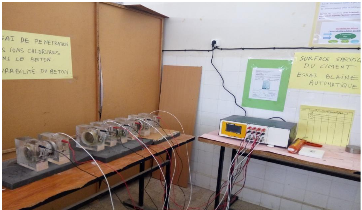
Figure III.20 : Appareil de mesure de pénétration des ions de chlorures dans le béton(Laboratoire Développement des Géo Matériaux, M'sila).
