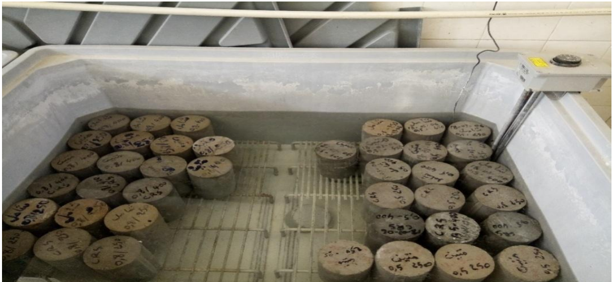
Figure III.17: cure dans l'eau à 20 °C pendant 28 jours(Laboratoire Développement des Géo Matériaux, M'sila).
