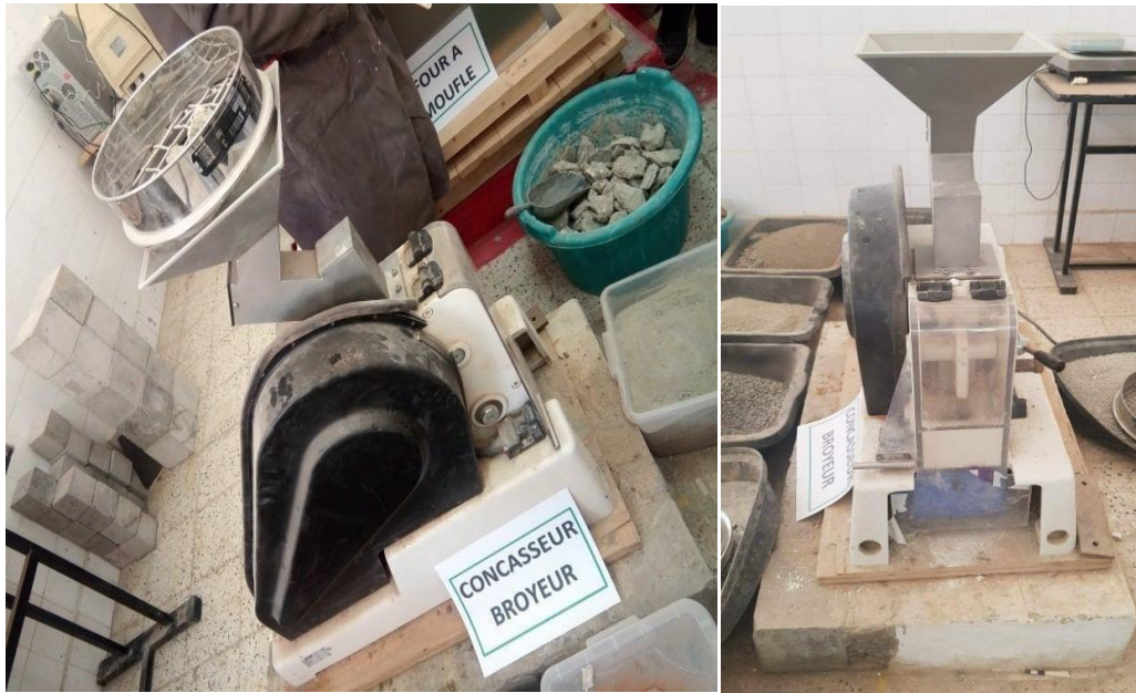
Figure III.15: Concasseur(Broyeur) utilisé pour préparer l'ajout(Laboratoire Développement des Géo Matériaux, M'sila).
