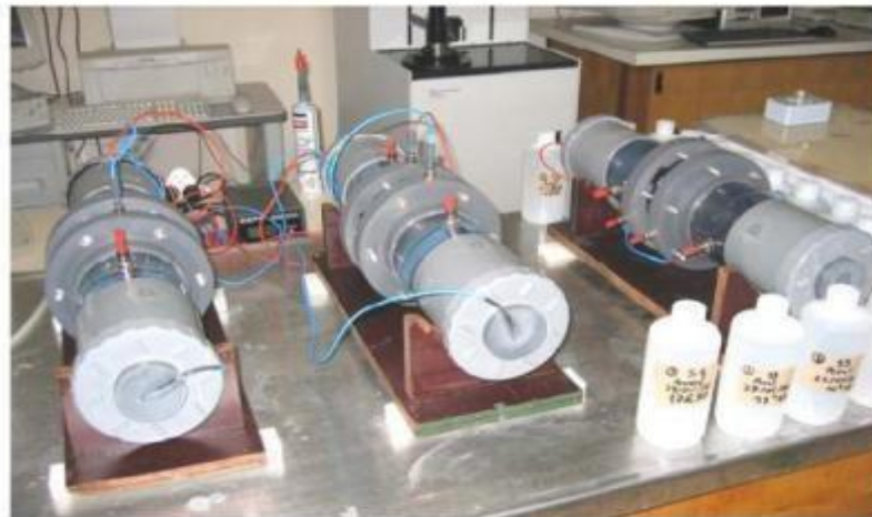
Figure II.21: Cellules de migration des ions chlorures, (Belarouci, A, 2011).
