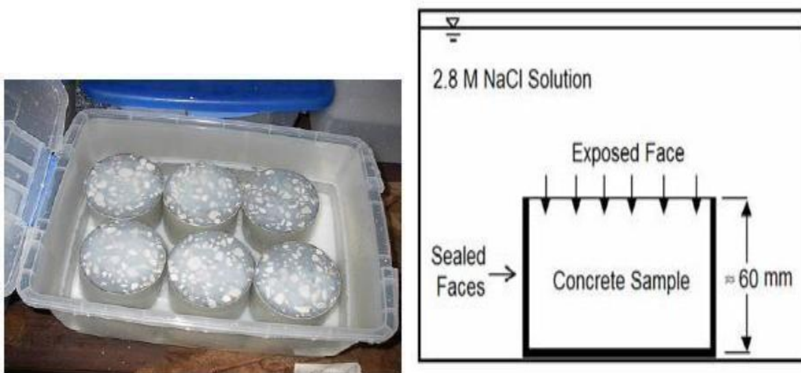
Figure II.19 : Essai d'immersion d'éprouvettes de béton selon NT Build 443, (Belarouci, A, 2011).
