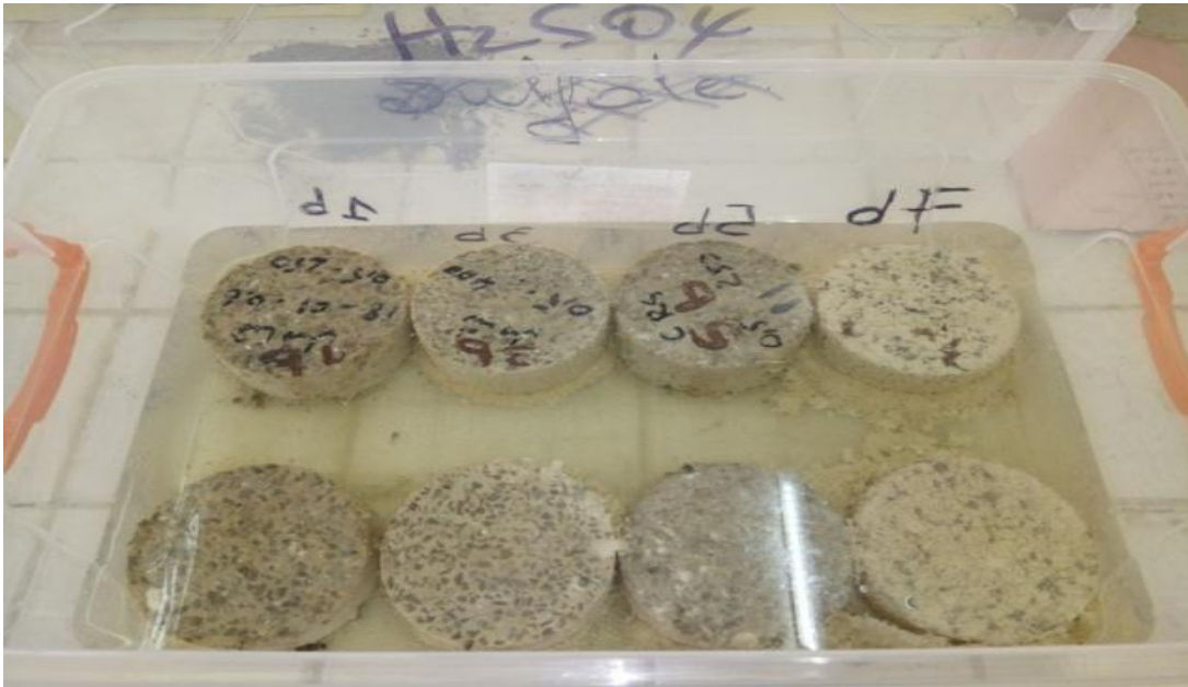
Figure III. 19: Cure agressive 0.5% de (\text{NH}_4)_2\text{SO}_4 (Laboratoire Développement des Géo Matériaux, M'sila).
