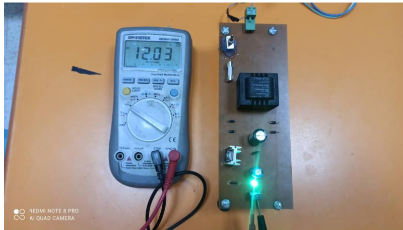
Figure III.10: Test de l'alimentation simple 12V.
