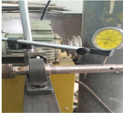
Figure IV.7 Vérification la rotation précise, régulière et sans vibrations
