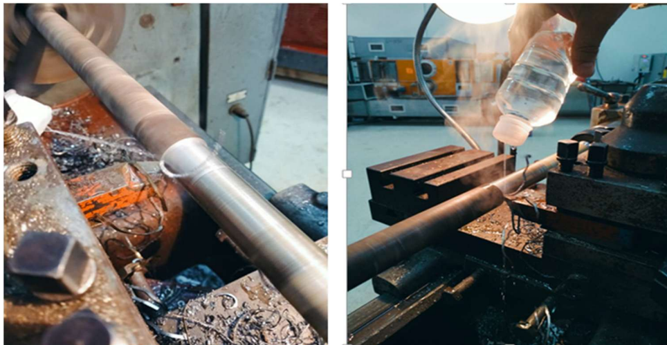
Figure IV.1 Usinage de l'arbre
