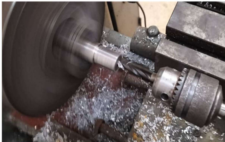
Figure IV.3 Perçage et taraudage de l'arbre
