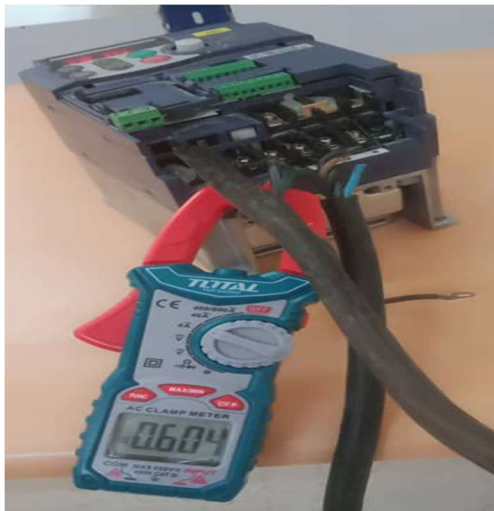
Figure IV.11 Mesure le courant absorbé par le moteur électrique du broyeur en charge
