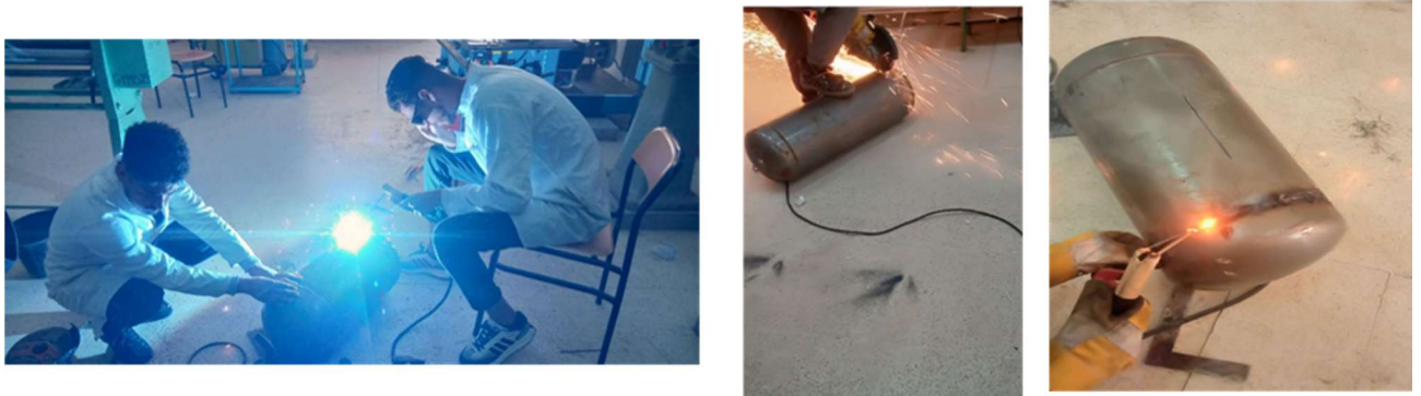
Figure IV.4 Les étapes d'adaptation de la bouteille à gaz
