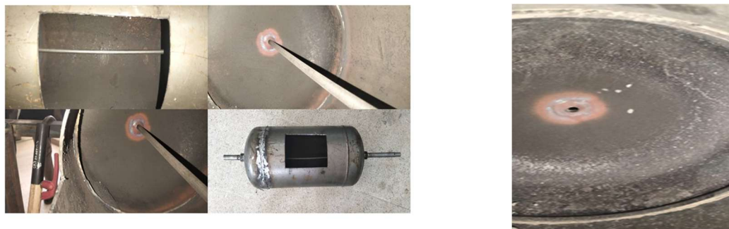
Figure IV.6 Les opérations de montage des deux arbres sur le tambour
