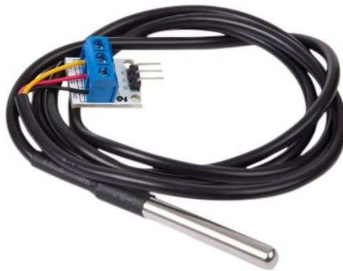
FigureII.17 : Image de la sonde de température DS18B20
