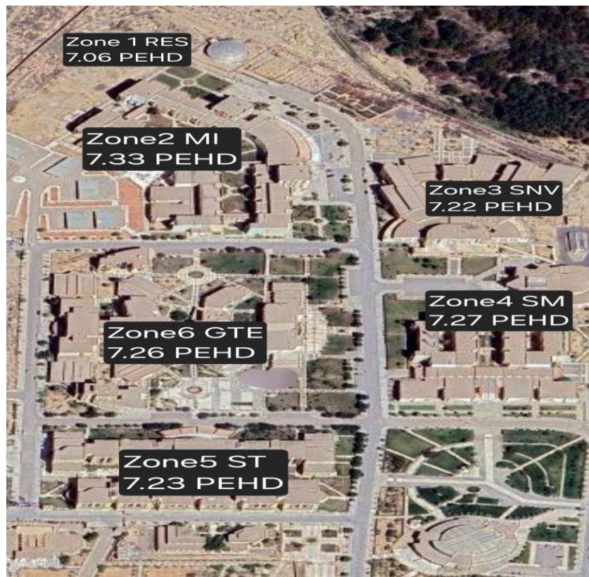
Figure III.36 : Augmentation du pH de l'eau distribuée de la zone principale RESV vers les autres zones
