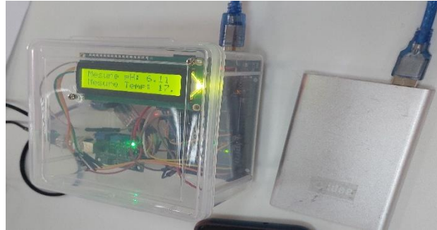
Figure III. 12 : Boîte prototype du montage, alimenté par un power Bank
