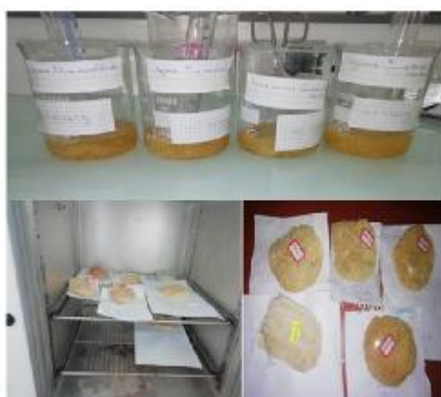
Figure IV.3: traitement des fibres par NaOH ( Effet des concentrations).
