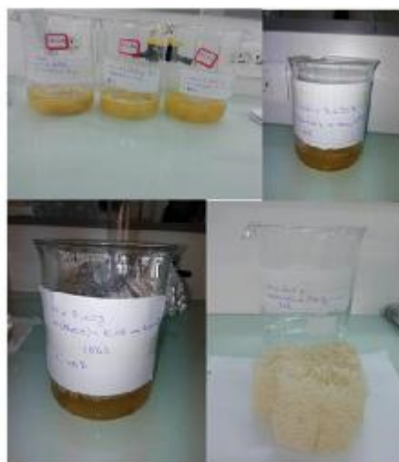
Figure IV.2 : traitement des fibres par NaOH ( Effet des temps).
