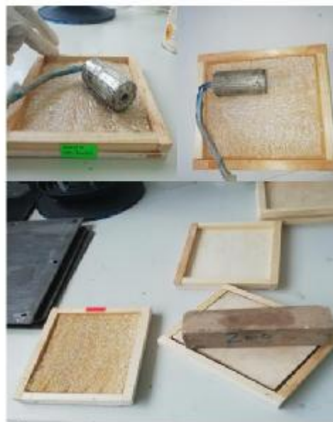
Figure IV.11 : le moulage par contact.
