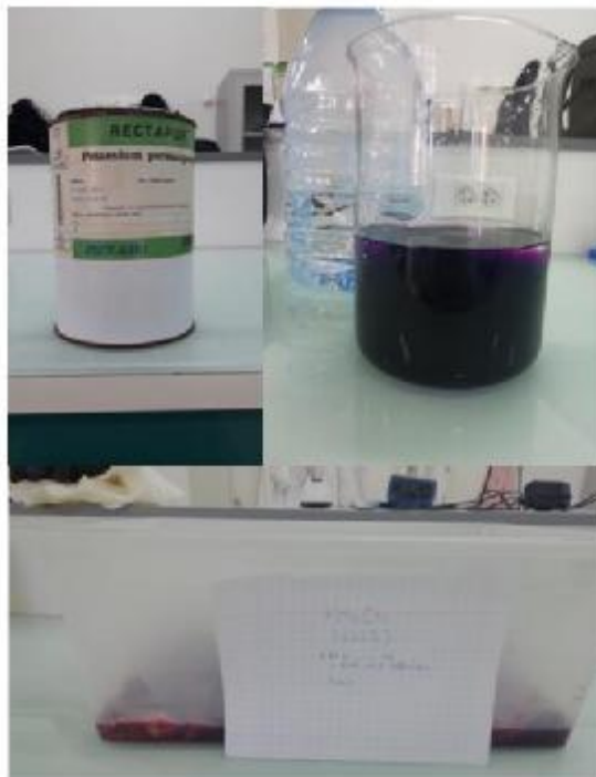
Figure IV.5: traitement des fibres par KMnO_4 .
