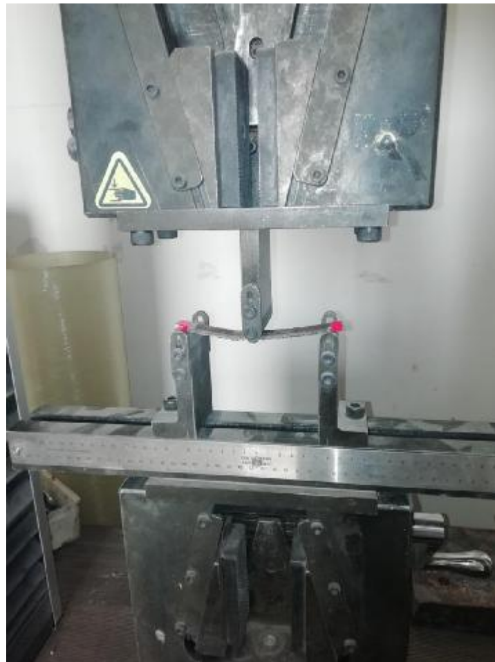
Figure IV.14 : l'essai de flexion sur une éprouvette.
