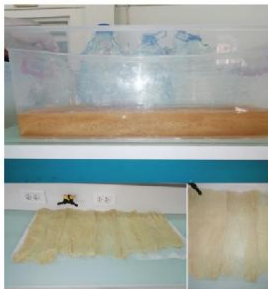
Figure IV.4: traitement des fibres par NaOH (5% m / 6h).
