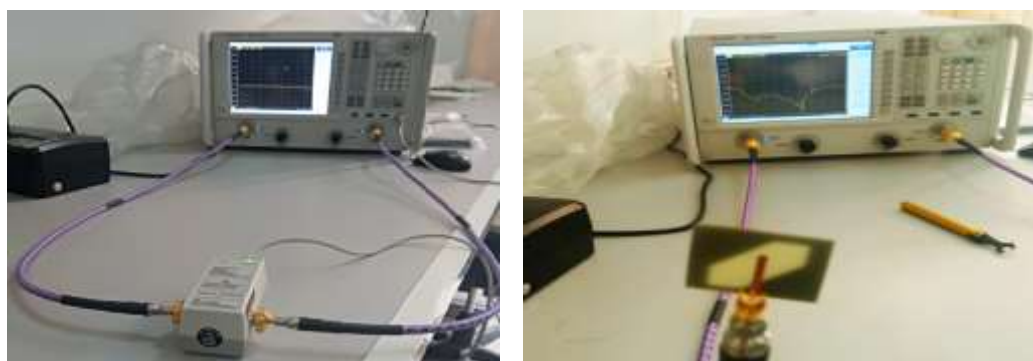
Figure IV.21 : Prototype fabriqué de l'antenne à ouverture.
