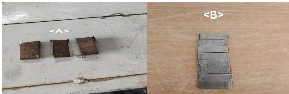
Figure 10: Matériau avant (A) et après(B) l'opération de polissage
