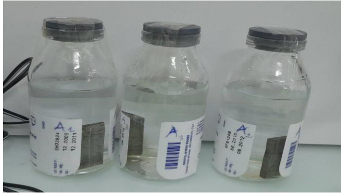
Figure 12: Corrosion sans inhibiteur d'électrode de travail
