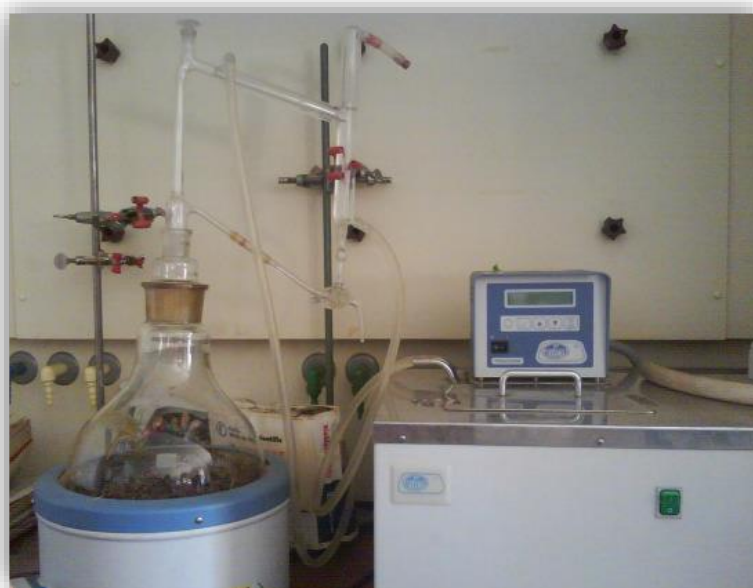
Fig. 5 : Montage d'hydrodistillation « Clevenger » [16].
